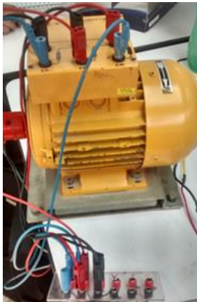
Imagen 3: Motor trifásico de 1.1KW, 6 terminales.
