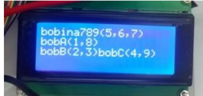
Imagen 8: Resultado obtenido de la prueba realizada a un motor de 9 terminales.
