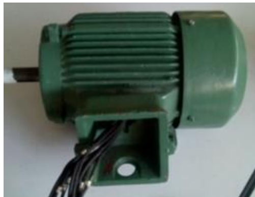
Imagen 9: Motor trifásico de 1KW de 12 terminales.
